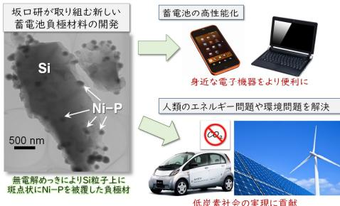
現在のリチウムイオン電池の負極は黒鉛ですが、次世代の負極材料としてその10倍近くもの高い理論容量を持つケイ素(Si)に期待が寄せられています。Siは低い電子伝導性や充放電時の大きな体積変化などの欠点を抱える材料ですが、当研究室ではSiと他の材料とのコンポジット化や不純物元素の添加などの工夫により、その欠点を克服した負極を開発しています。
